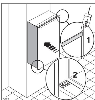
1. Вставить прибор в проём до тех пор, пока верхний стопор не упрётся в панель мебели.
