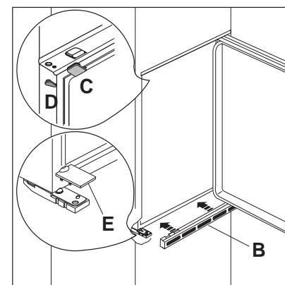
4. Установить вентиляционную решётку (B) и накладку петли (E), защёлкнув их. Вставить крышки (С-D) в отверстия петель.
