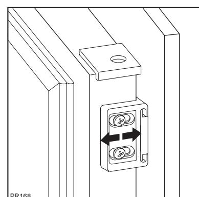
9. Для выравнивания двери шкафа пользуйтесь регулировочными прорезями. Выполнив эти операции, необходимо проверить плотность закрытия двери прибора.
